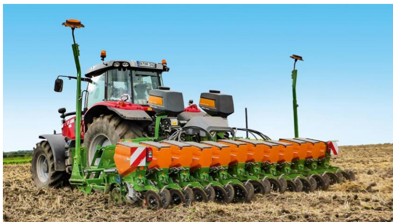
Рисунок 4 – Сеялка точного высева для пропашных культур ED
