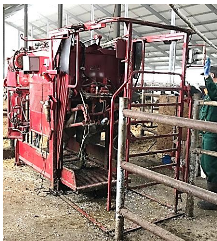
Рисунок 5 – Станок для обрезки копыт крупного рогатого скота «Comfort Chutes H-series» (ОАО «Канская сортоиспытательная станция» с. Бражное)
