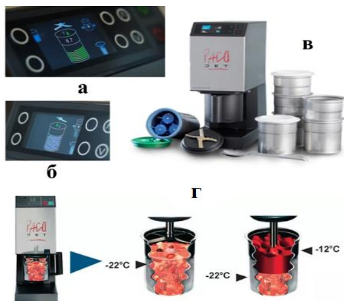
Рисунок 2 – Устройство и принцип работы PacoJet 2 (Швейцария):
