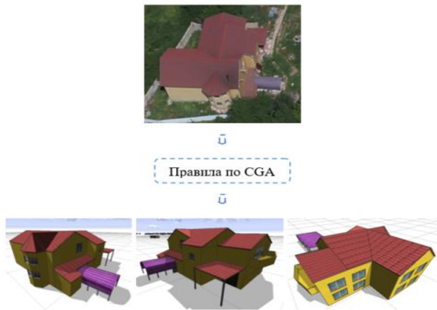
Рисунок 2 – Процесс построения фасада с использованием правил CGA и изображений по данным с БПЛА
