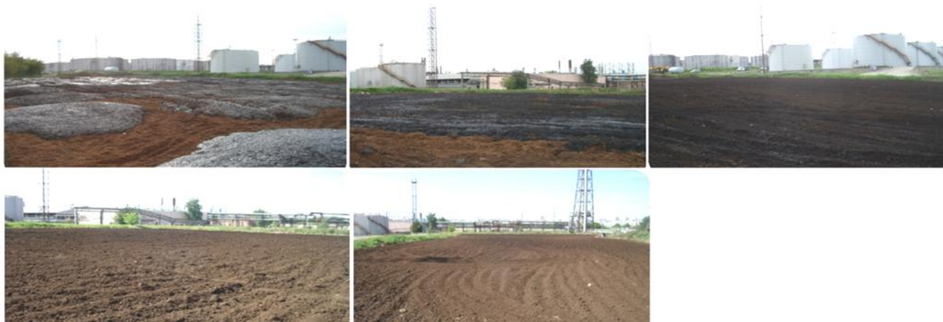
Рисунок 1 – Изменение внешнего вида нефтешлама в течение 40 дней обработки на Газпромнефть-МНПЗ
