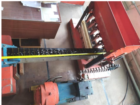
Рисунок 1 – Лабораторная установка для оценки равномерности зерновой струи
